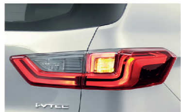
Emergency Stop Signal (ESS) สัญญาณไฟฉุกเฉินอัตโนมัติ ขณะเบรกกะทันหัน
