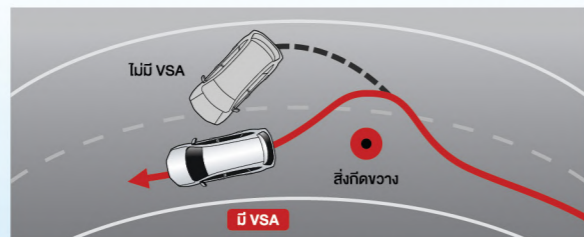
Vehicle Stability Assist (VSA) ระบบช่วยควบคุมการทรงตัวขณะเข้าโค้ง
